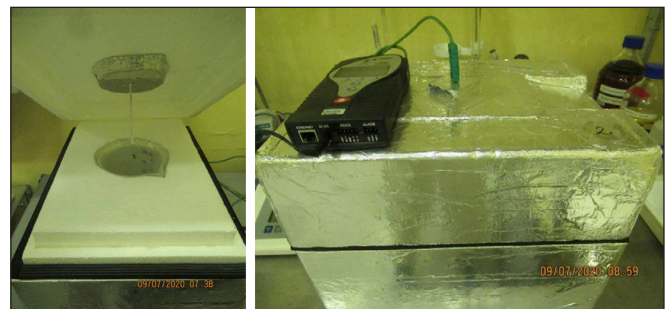
6. ábra: Polisztirol kaloriméter adatgyűjtővel
